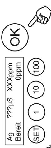
Das CM2000 misst die aktuelle Leitfähigkeit (µS) Ihres Wassers und zeigt Ihnen diese nach 3 Sekunden an, anschließend beginnt die Produktion. Die ideale Leitfähigkeit des Wassers beträgt bei SILBER 1-15µS. Bei allen anderen Elektroden kann diese auch höher sein.
